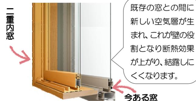
既存の窓との間に新しい空気層が生まれ、これが壁の役割となり断熱効果が上がり、結露しにくくなります。
